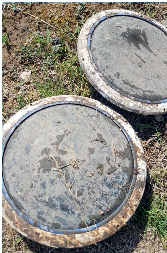
Rys. 3 | Dyfuzory membranowe po wymianie na oczyszczalni stosującej preparat DuoBent
